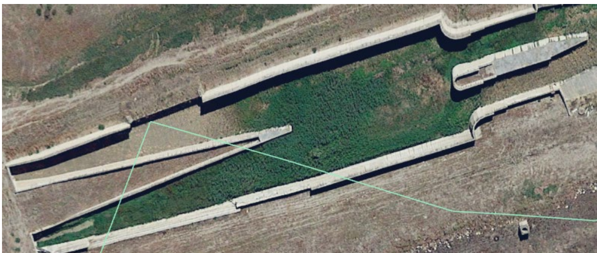
Figura 12.8: Vasca di dissipazione – Situazione attuale dopo riprofilatura del terreno a monte dei muri e pulizia dai detriti
