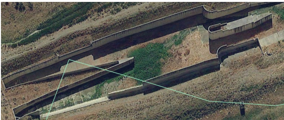
Figura 12.7: Vasca di dissipazione – Situazione dopo i crolli del 2016
